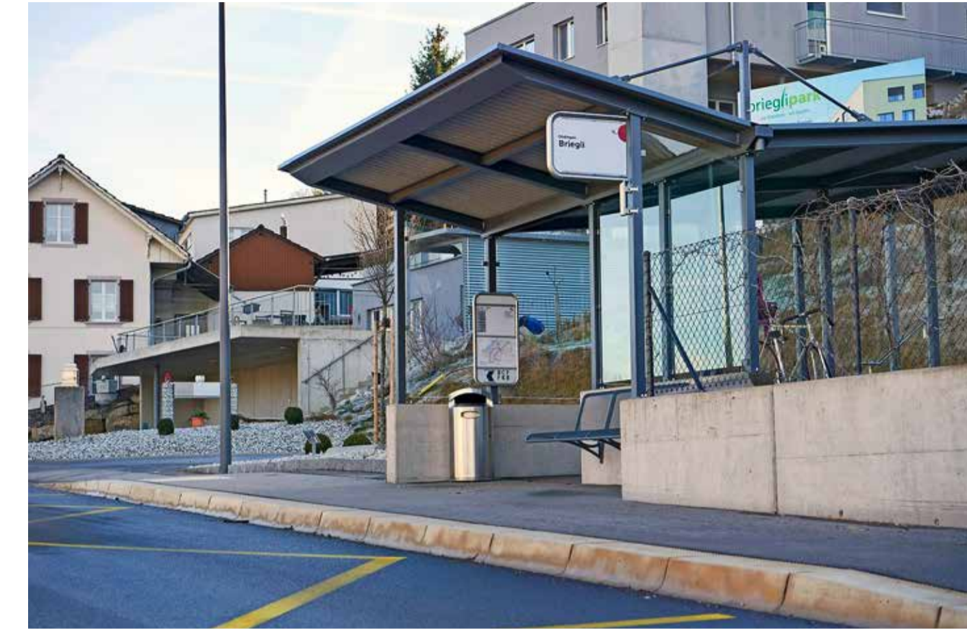
An vielen Haltestellen im Kanton ist die Kantenhöhe zum Einstieg in Busse ungenügend.
